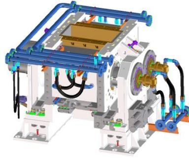
新标准总成设计使冷却管道在密炼室顶端
